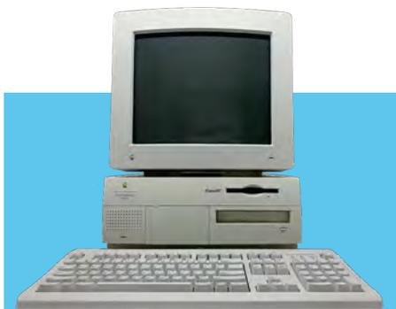
Mit CD- und Floppylaufwerk sowie SCSI-Schnittstelle waren die Rechner top. Mitte der 90er Jahre fassten die Festplatten zwischen 250 und 500 MB. Ein Flaschenhals, gerade für die Bildbearbeitung, waren die Grafikspeicher mit gerade mal 2 bis 4 MB.
